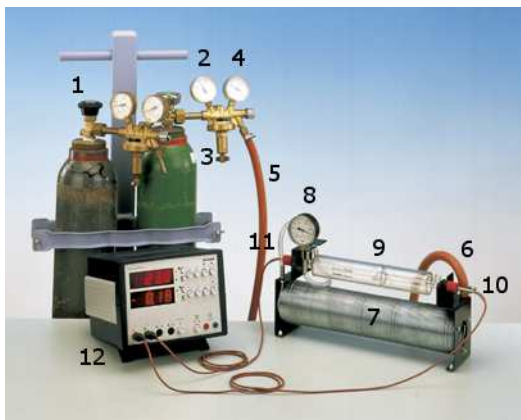
Obrázek 2: Sestavení aparatury pro měření Joule-Thomsonova koeficientu
